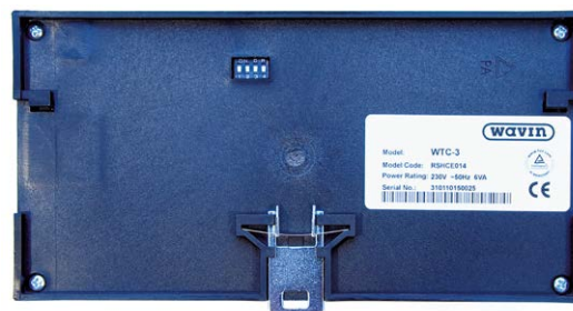
A sínre szerelhető WTC-3 szabályozó automatika hátoldala
