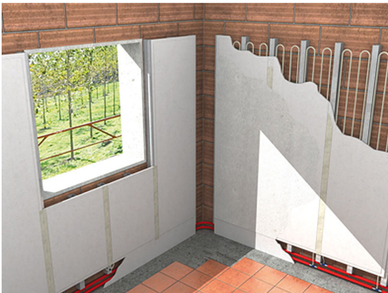
Példa a WD-10 modulok fali felerősítésére
