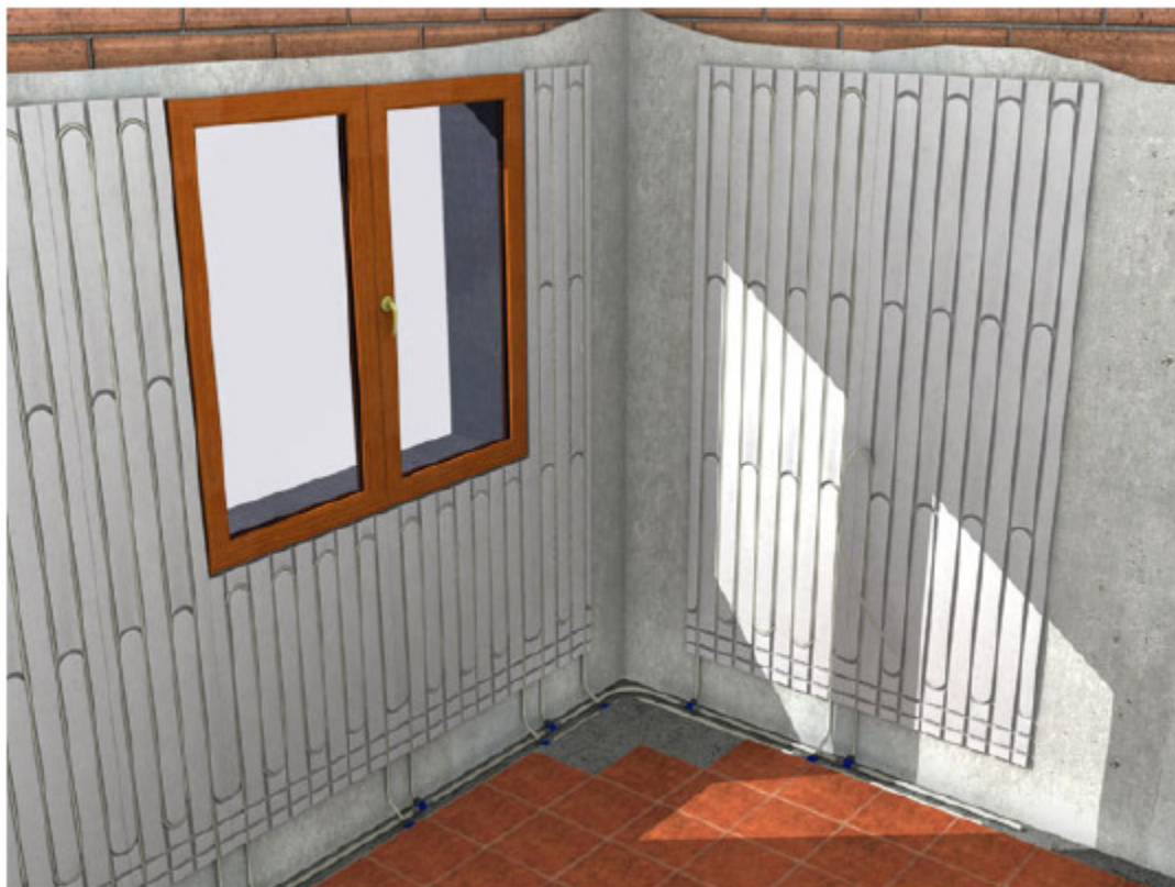
Példa az UNI-10 modulok fali felerősítésére
