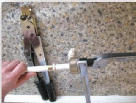
4. Toldóhüvely idomra történő ráhúzása, kötés véglegesítése
