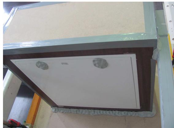
**Bild 14** Einbau der Revisionsklappe, mit Abdichtung für die Nullmessung
