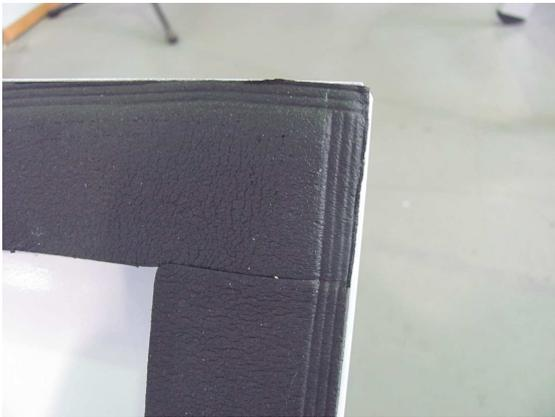
**Bild 3** Probekörper 1, Klappe mit EPDM-Moosgummi
