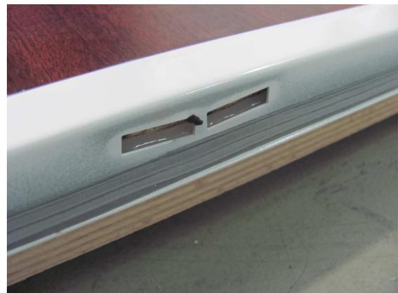
**Bild 8** Probekörper 1, Stanzungen im Rahmenprofil
