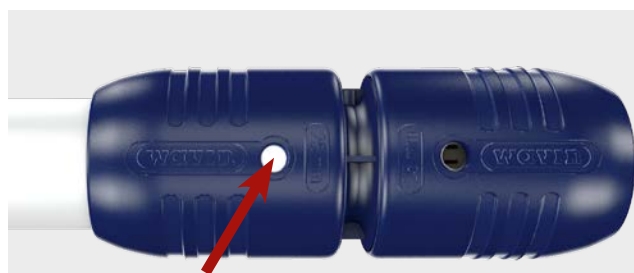
9. ábra: A kupakban található kémlelőnyíláson keresztül ellenőrizhető a cső ütközésig történő betolása
