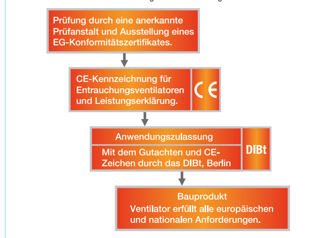
Bild 5 Bauaufsichtliche Anforderungen an Entrauchungsventilatoren
